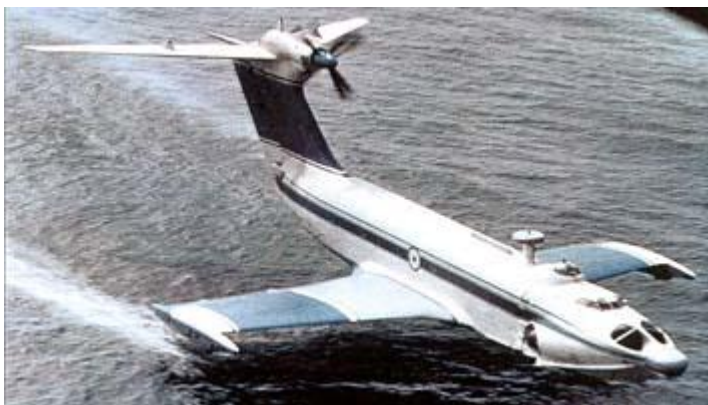
Рис. 3. Экраноплан (катер с крыльями) «Орленок» (вместимость 200 человек)
