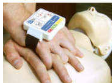
Рисунок 2. Помощник реаниматора ПР - 01ПП - устройство контроля качества проведения непрямого массажа сердца (НМС) с голосовыми подсказками при проведении сердечно-легочной реанимации (СЛР).
