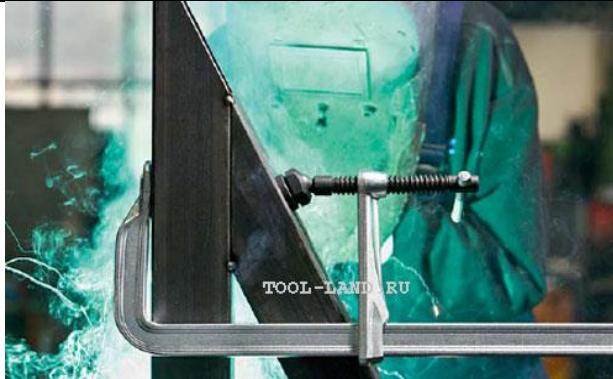
**1.** Струбцина с регулируемым зевом и наклоняемым упором: применение
