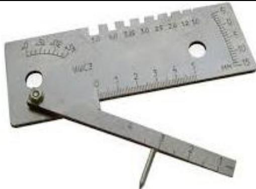
**1. Технология контроля прихваточных швов посредством УШС (универсальный шаблон сварщика).**
