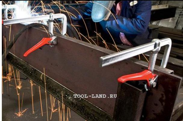
**1. Быстроажимные струбцины с регулируемым зевом: назначение, принцип действия.**
