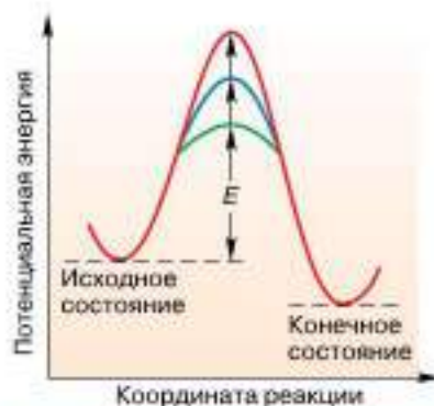
Рис. 3.9. Энергия активации реакции: красная линия — без катализатора; синяя — с участием неорганического катализатора; зелёная — с участием фермента
